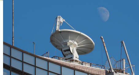
研究などに活用される直径約3メートルのパラボラアンテナ
