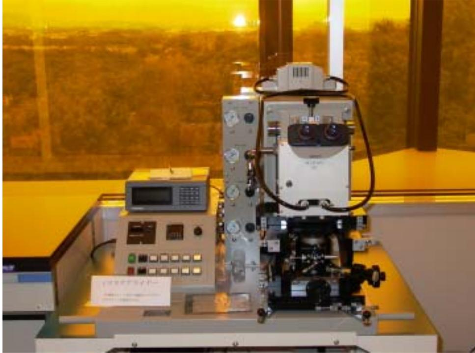
半導体製造のホトリソ工程においてシリコンウエーハ、ガラスなどの基板に対して、高精度に製作されたマスクガラスのパターンをマイクロレベルの精度で位置合わせとパターン焼付けを行う装置です。
