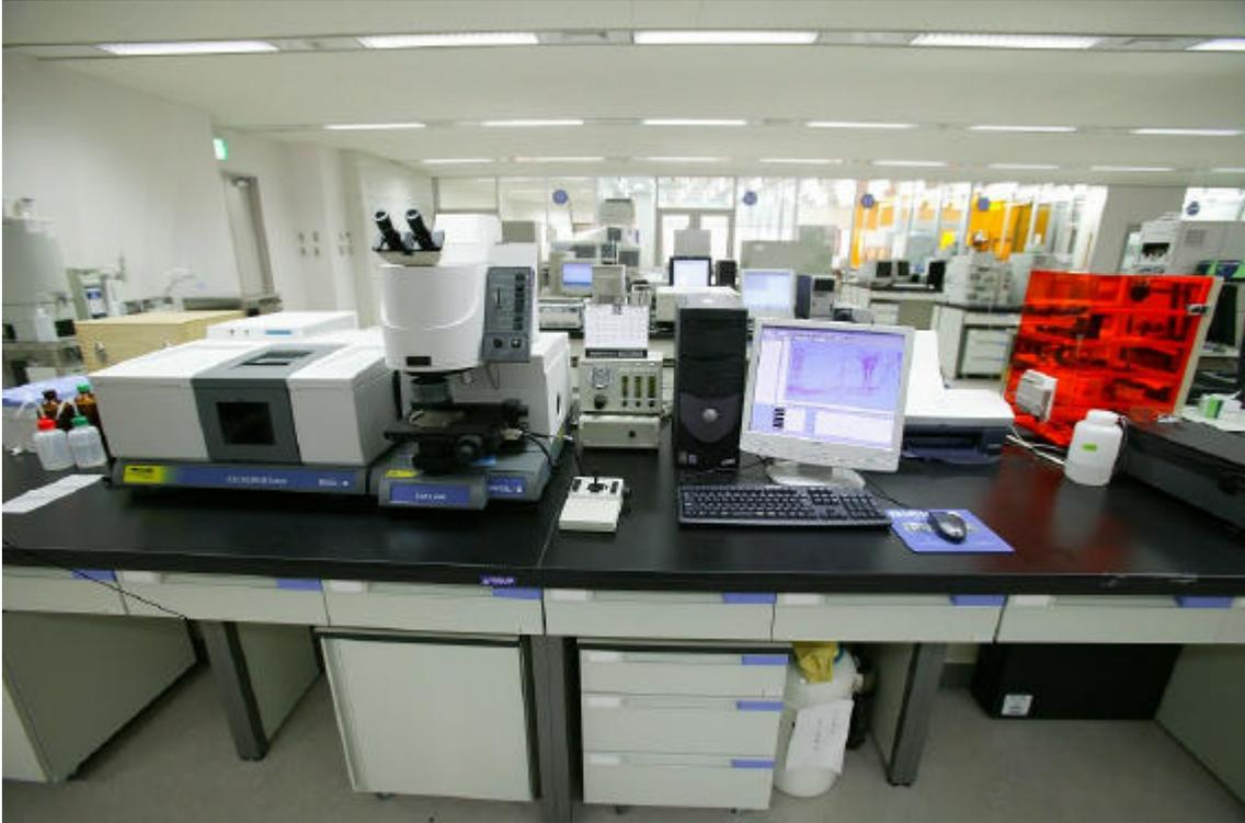
高分子化合物などの材料表面に赤外線を照射して目的とする試料の結合状態を調べることで、材料の化学構造に関する情報を得ることのできる装置です。特にこの装置は二次元での解析が可能であり、ナノファブリケーションの研究にも応用できます。DNAチップ、プロテインチップなどの表面に形成されたナノコーティング層の化学構造、さらにその化学構造の表面上でのマッピングが観察でき、最高感度のチップを作製する指針の獲得が可能です。
