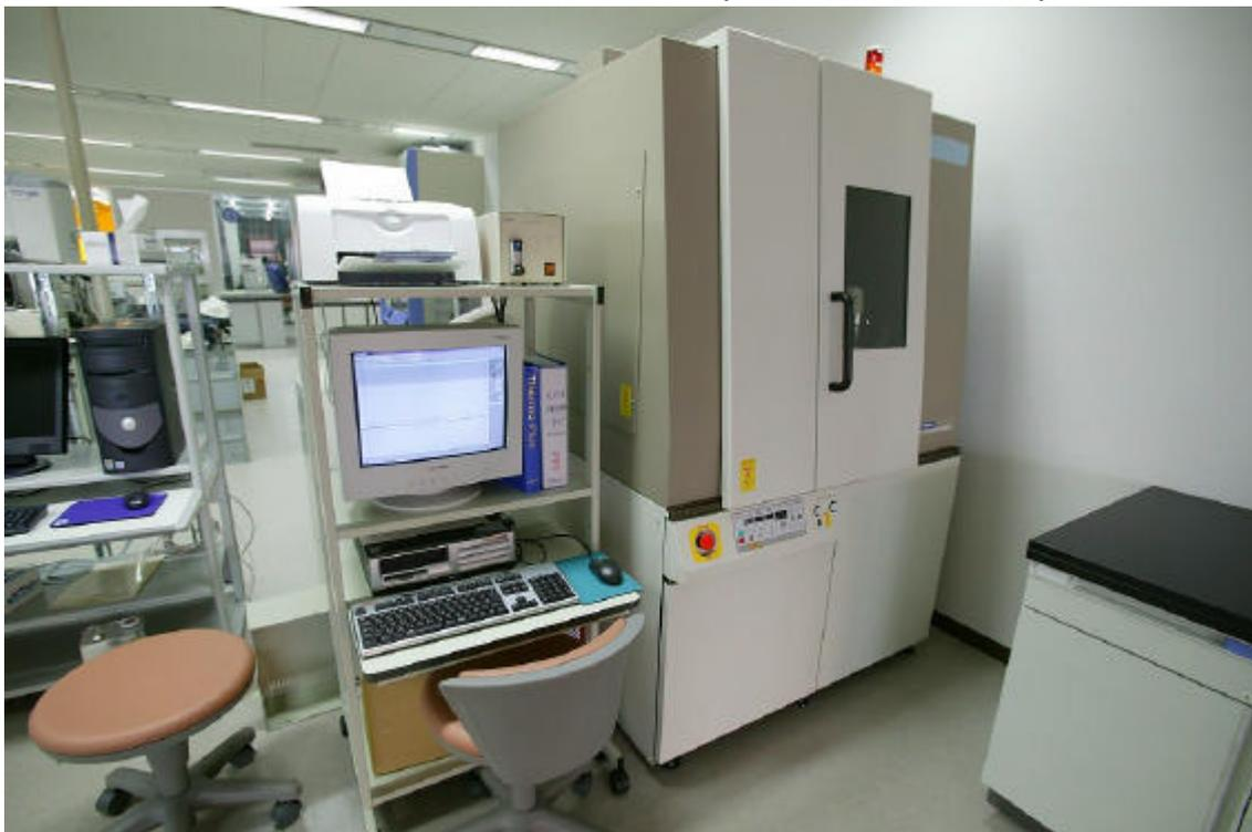
X線を照射することにより様々な物質の構造を解析し、同時に相転移も測定できる装置です。この装置は汎用性が高く、様々な物質の化学的、物理的な性質を測定するのに使われます。
