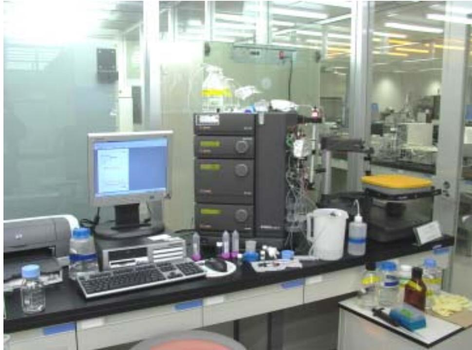
精製スキームのさまざまな条件検討の自動化に対応しています。タンパク質のみならず、ペプチド、オリゴヌクレオチドの精製から精製度の確認、ペプチドマッピングまで、一台でフルラインの生体分子精製をサポートします。また、サンプルポンプによる200までのサンプルを自動添加できます。
