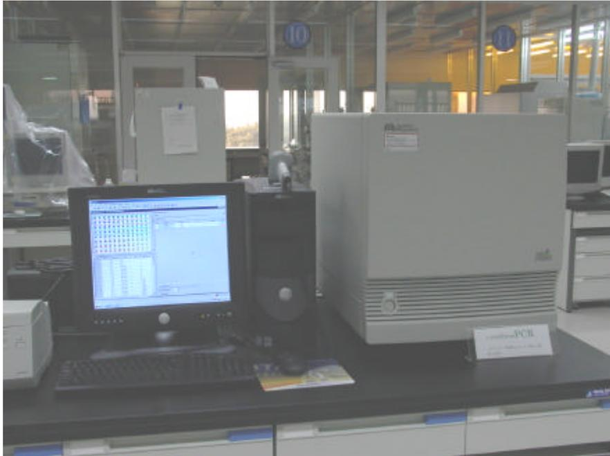
多サンプル処理が可能なリアルタイム PCR システム。蛍光 5' ヌクレアーゼアッセイもしくは SYBR Green I Dye アッセイが行えます。マルチプレックス遺伝子発現定量や、2色ラベルのプロープによる SNP s タイピング解析に適しています。
