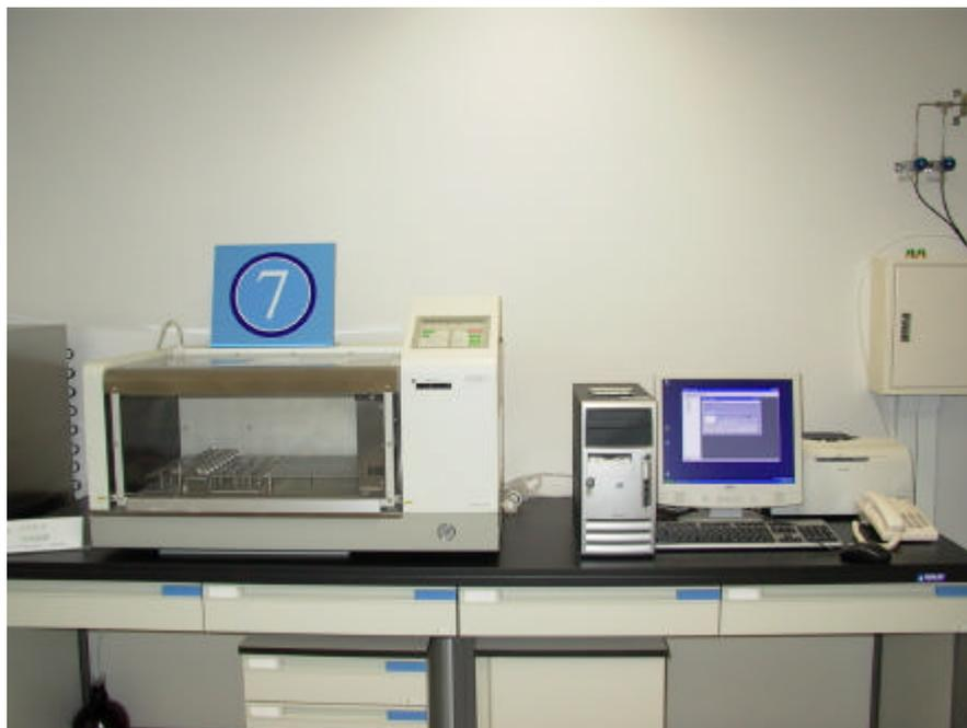
抗体の作成やエピトープマッピング、構造活性相関等の研究のためのペプチドのルーチン合成に使用できます。安全性、操作性に優れ、同時クリーンページも可能で、副反応も少ない高効率ペプチド合成装置です。必要量の高純度ペプチドが、同時に8種類、ルーチンでしかも経済的に合成できます。
