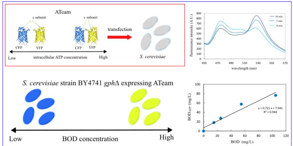
**研究成果:** ATP を測定するために、シアン蛍光タンパク質と黄色蛍光タンパク質の間に細菌由来 ATP シンターゼ ε サブユニットを含む人工タンパク質(ATeam)を発現する酵母を作製した。この酵母を用いることで FRET に由来する酵母の蛍光色変化で BOD を連続的に測定することが可能になった。実際に、細胞内 ATP を使用して評価した BOD 値と 5 日間 BOD 検査を使用して評価した BOD 値の間の相関は、 $R^2 = 0.944$  の直線関係があることが示された。
